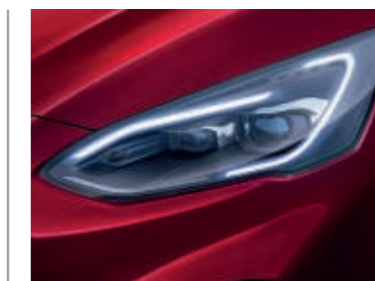
Adaptief verlichtingssysteem voor met dynamische led-koplampen, verblindingsvrij grootlicht en sequentiële led-richtingaanwijzers
